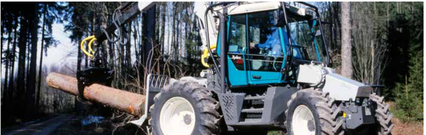
Einer der ersten Xylon-Schlepper, der durch die Firma Pfanzelt für den Forsteinsatz umgebaut wurde.
