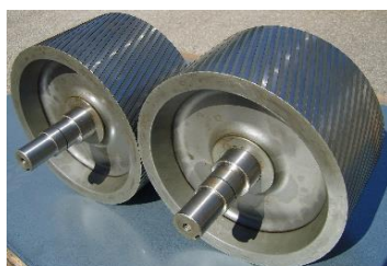
gehärtete Walzen aus Vollmaterial
