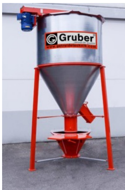
Bild: Futtermischer FM 1000 mit Beimischtrichter staubdicht, Mischerauslauf mechanisch
