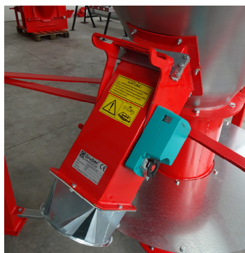
Bild: Mischerauslauf elektrisch mit Übergang eckig auf rund
