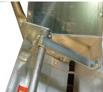
Einlaufregulierung mit Spindelverstellung (sperrt den Getreidezulauf komplett ab!)
