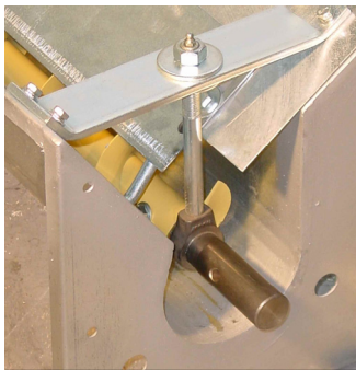
Zwischenlager (Gleitlager) mit Haltebügel und Schmiernippel
