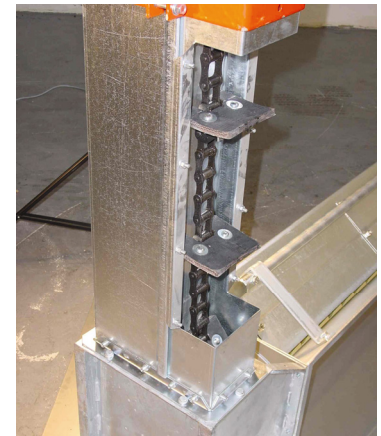
Gefalzter Elevatorschacht mit genormter Stahlrollenkette und gestanzten Gummimitnehmern
